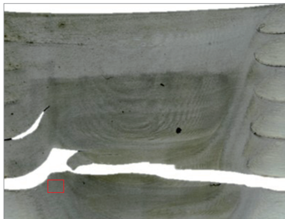
图 7 增材构件剪切断裂位置
